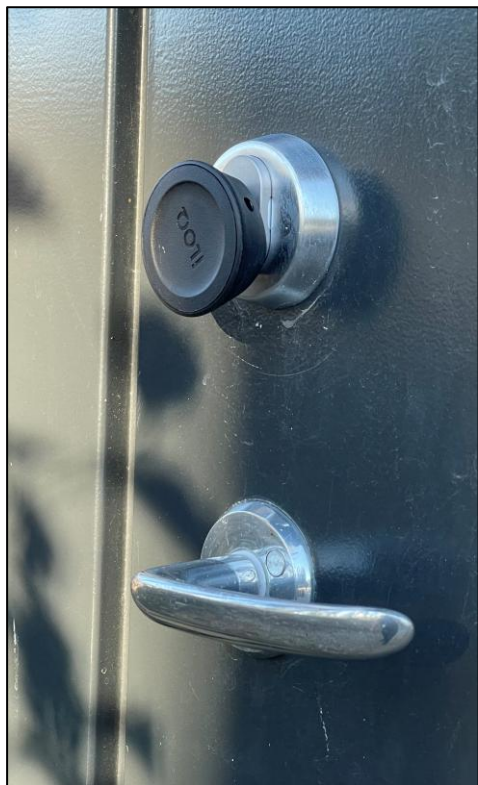
Figur 28a og b: Batterilaust smartnøkkelsystem iLoq som vert operert via RFID, NFC og tilgangssapp på mobiltelefonen.
